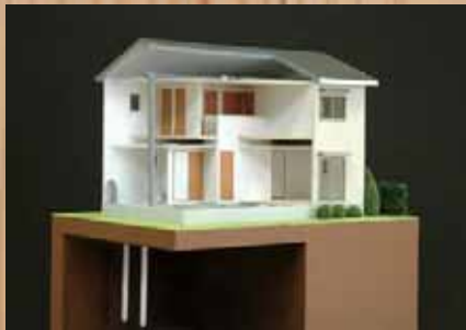
地中に5メートルのアルミ製のパイプを埋めています。
